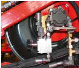
Load Sensing Привод вентилятора
