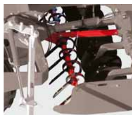
Выравнивающая балка перед почвоуплотнителем
