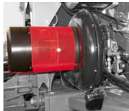
Вентилятор Пылезащитный фильтр
