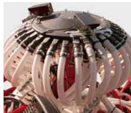
Переключение техно- логической колеи симметрично - асимметрично
